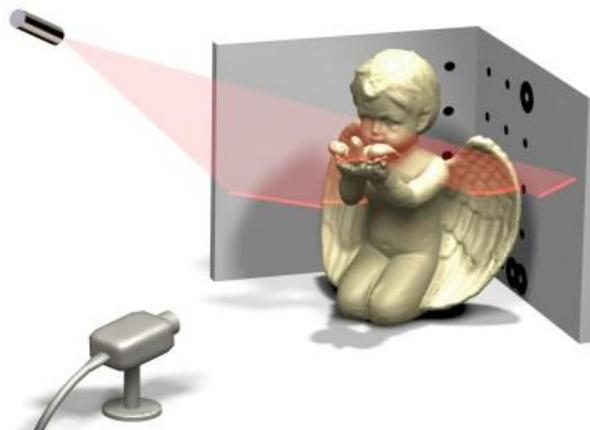
Figura 3: Esquema de triangulação utilizado em Scanner 3D
